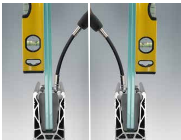
6. Uitlijning van het glas door de bouten los of vast aan te draaien. Controle op exact aangewend koppel: 3 Nm.
